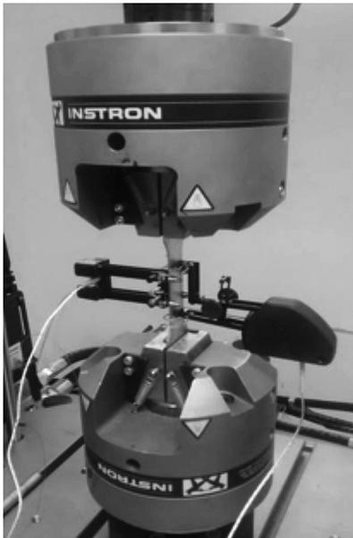
**Figura 1.** Configuración de la probeta en la prueba de tensión experimental.
