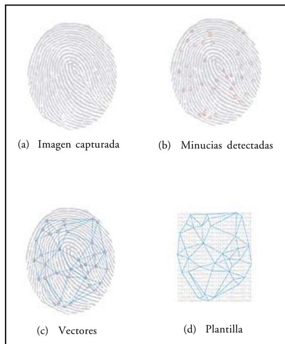
Figura 5. Proceso de modelado de coordenadas cartesianas.
