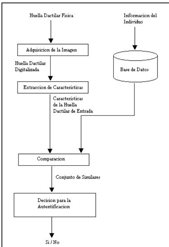
Figura 3. Diagrama de Bloques de un Sistema AFAS.
