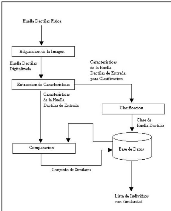
Figura 2. Diagrama de Bloques de un Sistema AFIS.
