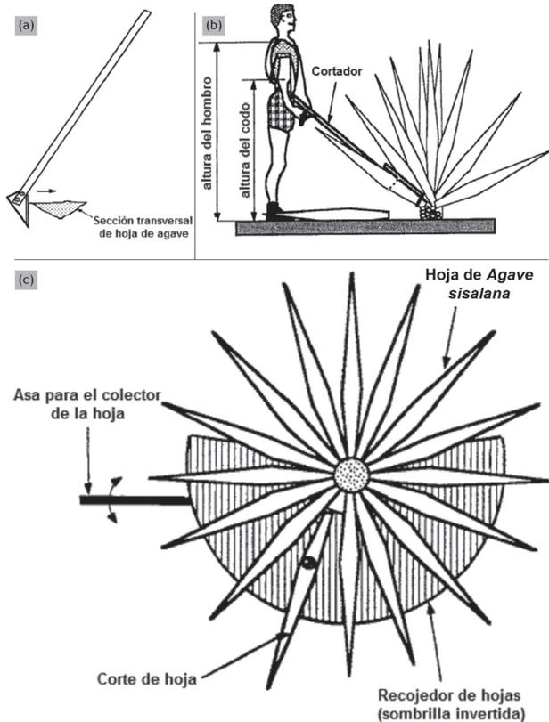
Figura 5. Dispositivos mecánicos para disminuir el arduo trabajo de la cosecha de agave sisal; (a) poste con cuchilla; (b) dispositivo de corte tipo sierra; (c) dispositivo de corte tipo cizalla.
