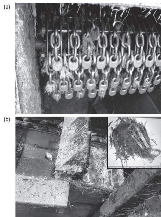
Figura 9. Fase de desmenuzado; (a) molino de cadenas; (b) desfriado de la segunda fase.
