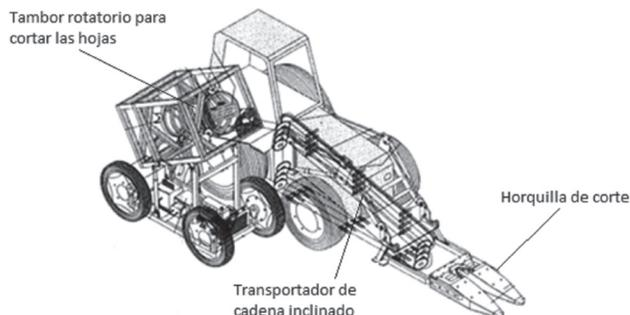
Figura 3. Máquina cosechadora-jimadora de *Agave tequilana* Weber.
