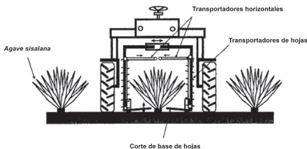
Figura 4. Cosechadora mecánica autopropulsada para agave sisal.
