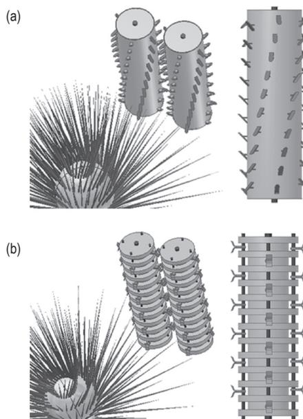
Figura 14. Dispositivos para el corte y troceado (fase de trituración); (a) rodillos de series de cuchillas helicoidales fijas; (b) rodillo de series lineales de cuchillas articuladas.
