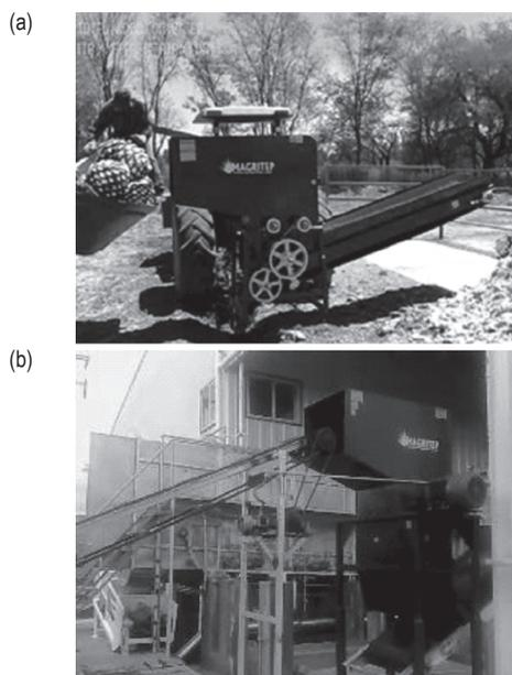
Figura 7. Molino picador de agave; (a) accionado por el tractor; (b) con motor eléctrico.
