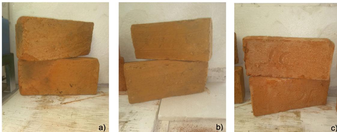
**Figura 4.** Ladrillos sinterizados con sedimentos provenientes de a) comunidad de El Encinal, b) comunidad Irapuato, y c) Presa La Esperanza, Guanajuato.
