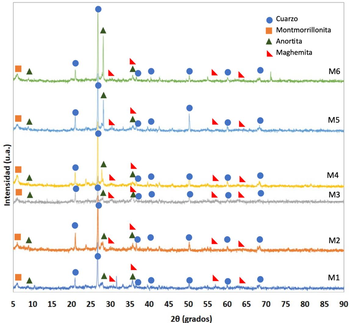
Figura 5. Patrones de difracción de rayos X de los sedimentos obtenidos de la presa de La Esperanza, Guanajuato.
