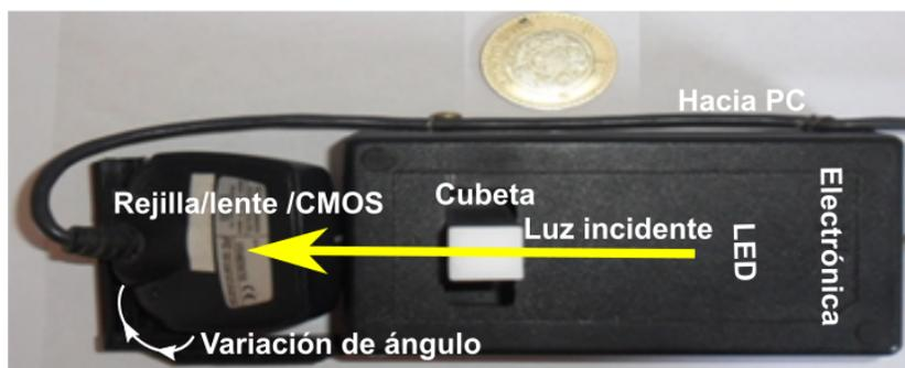
Figura 6. Espectrofotómetro digital visto desde la parte superior y la ubicación espacial de sus componentes.
