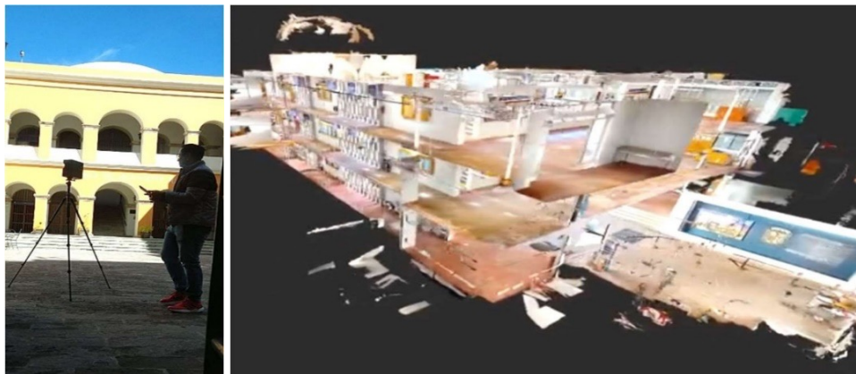
Figura 6. Evidencia de digitalización 3D de la sede Belén (equipo Matterport).
