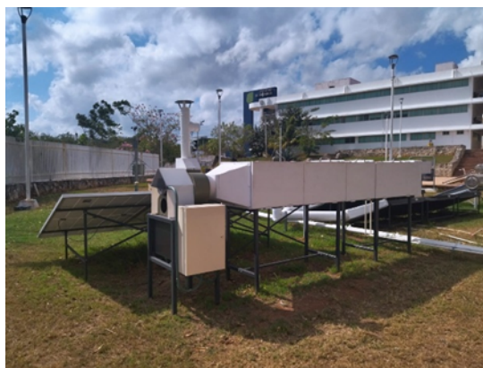
Figura 3. Secador solar indirecto tipo túnel empleado en el experimento. Se observa la cámara de secado con bandejas, el ducto de distribución de aire y el módulo de colectores solares acoplados a intercambiador agua-aire.
