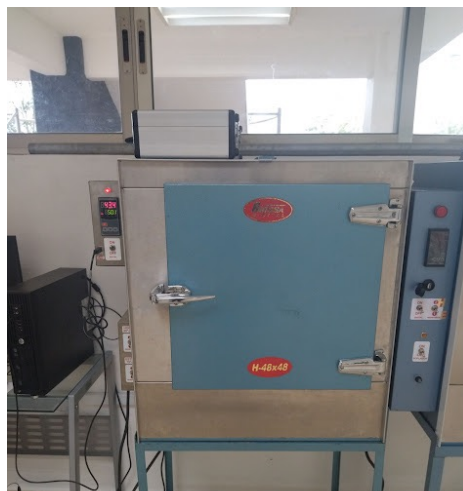
Figura 4. Horno eléctrico no convectivo (marca Riossa) empleado en el proceso de deshidratación de mango a temperatura constante de 50.1 °C.
