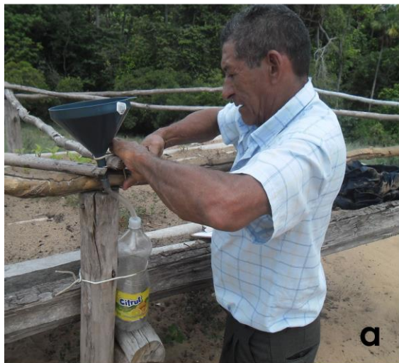
Figura 3. (a) Ensamblaje del pluviómetro alternativo; (b) Proceso de lectura de la lámina de agua recolectada por el pluviómetro alternativo.
