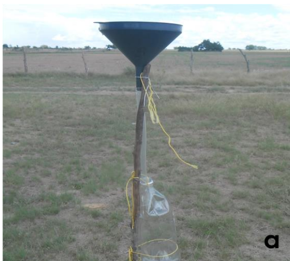
Figura 2. (a) Pluviómetro alternativo; (b) Explicación de las normas de instalación del pluviómetro a miembros del consejo comunal.
