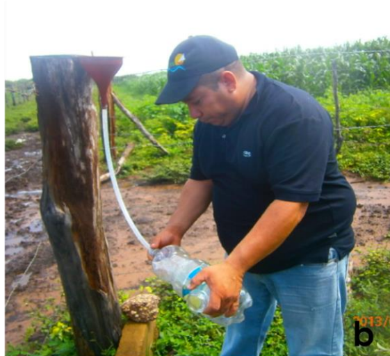
Figura 3. (a) Ensamblaje del pluviómetro alternativo; (b) Proceso de lectura de la lámina de agua recolectada por el pluviómetro alternativo.
